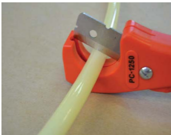
PEX-røret afkortes vinkelret. Det gøres nemt med en rørsaks.
